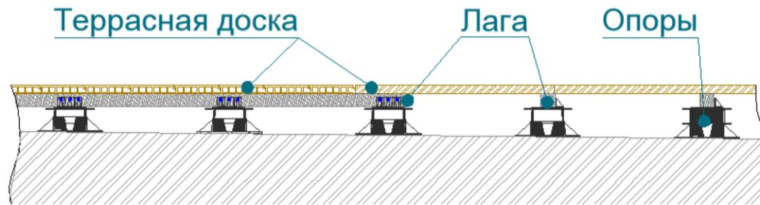
Максимальная статическая нагрузка на одну опору составляет 1000 кг. В случае динамической нагрузки показатель прочности необходимо брать меньшим и производить дополнительные расчёты. Начинать монтаж следует с краёв покрытия, смыкающихся со стенами или ограждениями. Производить разметку расстановки опор необходимо с учётом верхнего "чистового" покрытия. Шаг между опорами может быть от 400мм до 600мм. Опоры устанавливаются на равноудалённом расстоянии
