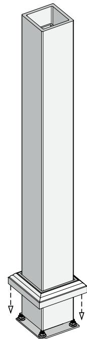
На столбах монтируются верхние уголки при помощи саморезов. Перед монтажом убедитесь, что все уголки монтируются на одной высоте. Во избежание прокручивания саморезов в столбах, предварительно просверлите небольшие отверстия сверлом.
