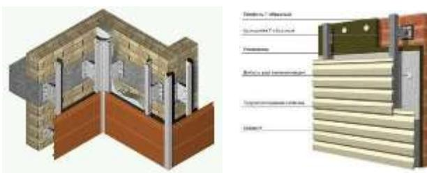
**Вне зависимости от выбранного варианта подконструкции первая и последняя направляющие профилей должны быть закреплены на углах здания и исключать провис фасадной панели на подконструкции по торцам более чем на 10 мм с каждой стороны.**
